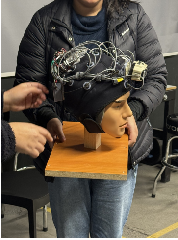
(a) Gorro EEG de 16 canales montado sobre la cabeza de calibración usada en la preparación.
