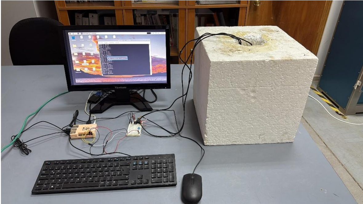
Figura 1.1: Calorímetro de bajo costo elaborado por (Fuentes Ciocca, 2025) dentro del grupo de investigación.
